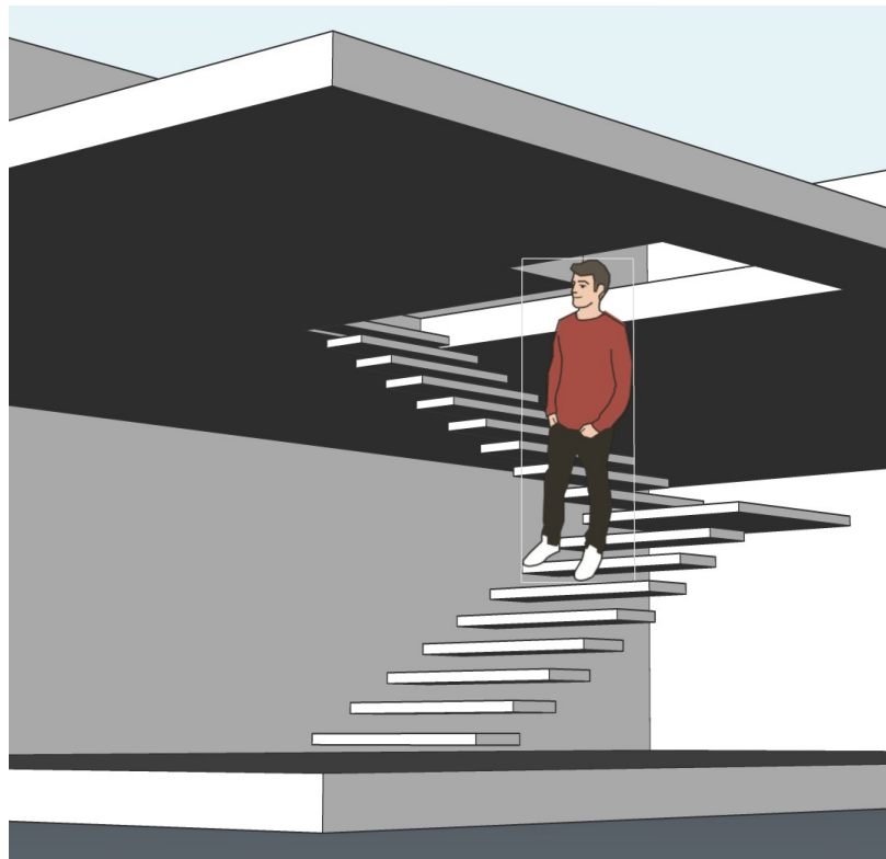
Abb. 218: BIM-Treppe mit 2 m Kopffreiheit
