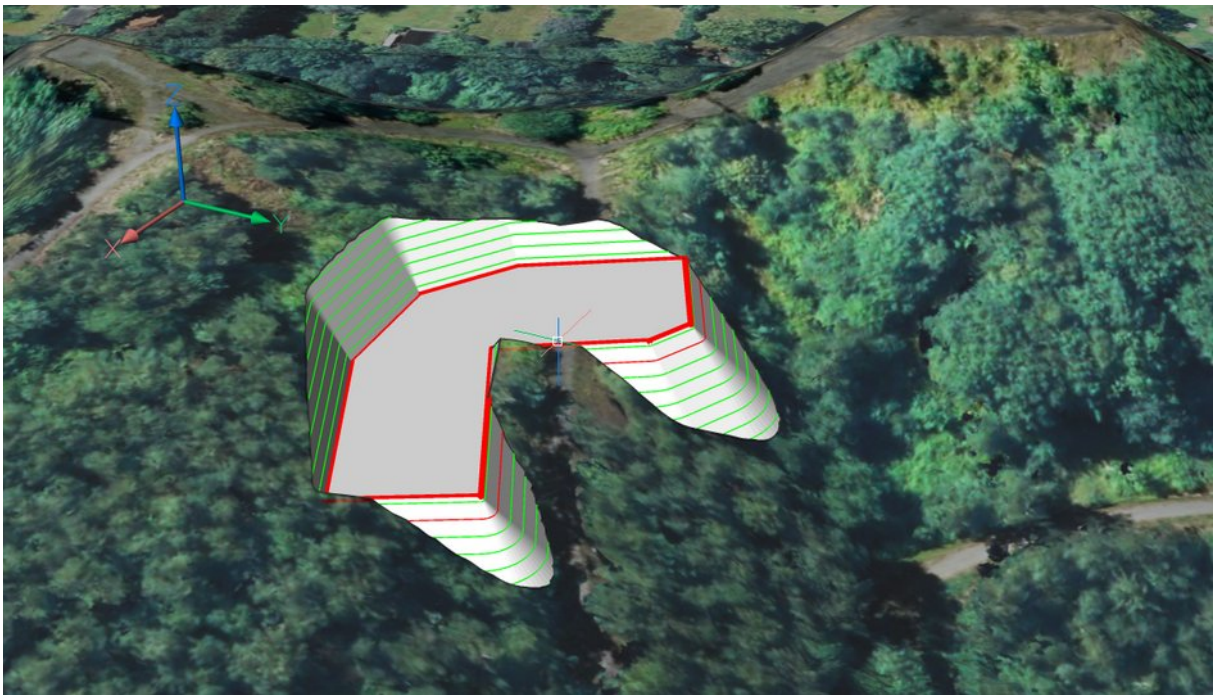
Abb. 214: Planum mit Aushub und Auftrag
